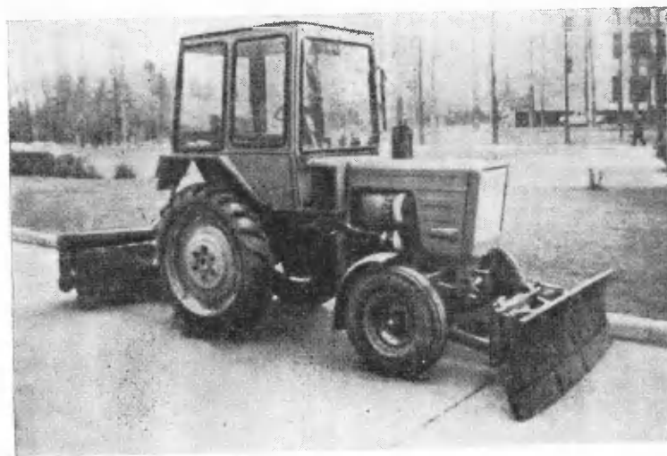
Рис. 43. Универсальная машина для ухода за зелеными насаждениями УСБ-25 со снегоочистным оборудованием
