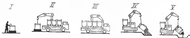
Рис. 16. Технологическая схема вывоза мусора контейнерным мусоровозом по системе сменных сборников
